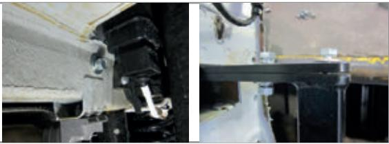
**ШАГ 3.** Закрепите каждую закладную пластину в ближнем отверстии с помощью болта M10x1,25x40 через шайбу 10 гроверную и шайбу 10. Затяните все резьбовые соединения. Перед установкой бампера наклейте на нижнюю юбку бампера шаблон по центру бампера и аккуратно вырежьте по контуру шаблона отверстие в бампере.
