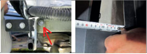
**ШАГ 4.** Установите бампер и фонари на место. Установите кронштейн нижний, совместив отверстия в нём с отверстиями в балке ТСУ. Закрепите нижний кронштейн с помощью болтов M12x1,25x120 и гаек M12x1,25 с нейлоном. Установите кронштейн розетки, закрепив его на шпильке гайкой M10 через шайбу 10 увеличенную и шайбу 10 гроверную.
