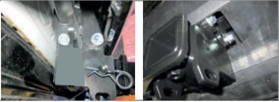
**ШАГ 5.** Установите съёмный шар в сборе и закрепите его пальцем гнутым гальванизированным со шплитом пружинным игольчатым. Затяните шар ключом на 38 мм. Установите фиксирующий болт M10x20 снизу, он используется для исключения технологических люфтов съемного шара и только в ненагруженном состоянии! Перед сцепкой болт демонтировать!
