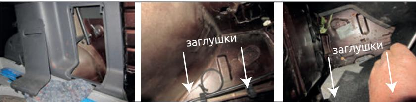
**ШАГ 2.** С помощью плоской отвертки найдите скрытые в лонжероне технологические отверстия. Проденьте болты M10x90 с надетыми на них шайбами 10 увеличенными и втулками в отверстия через багажник автомобиля. Демонтируйте заглушку, указанную на фото. В отверстие поместите закладную шпильку M10x40.
