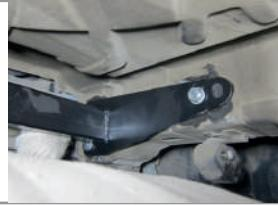
**ШАГ 3.** Отрегулируйте положение приемной трубы фаркопа относительно заднего бампера автомобиля. Затяните все резьбовые соединения. Установите глушитель автомобиля на штатные места.
