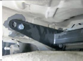
**ШАГ 4.** Установите кронштейн розетки, закрепив его на шпильке гайкой M10 через шайбу 10 увеличенную и шайбу 10 гроверную. Установите съемный шар в сборе и закрепите его пальцем гнутым гальванизированным со шплитом пружинным игольчатым. Затяните шар ключом на 38 мм. Установите фиксирующий болт M10x20 снизу, он используется для исключения технологических люфтов съемного шара и только в ненагруженном состоянии! Перед сцепкой болт демонтировать!
