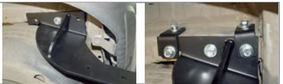
**ШАГ 4.** Установка правого кронштейна производится аналогично установке левого кронштейна, соединения не затягивайте.
