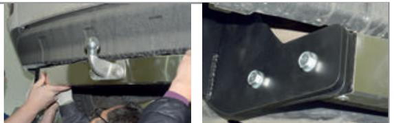
**ШАГ 6.** Отрегулируйте положение фаркопа, обеспечив небольшой зазор между центральным кронштейном и бампером автомобиля. Установите кронштейн розетки, закрепив болтом М10х20, шайбой 10 и шайбой 10 гроверной.
