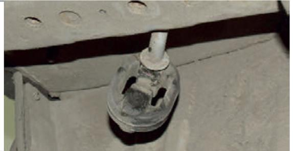
**ШАГ 3.** Установите левый кронштейн совместив отверстия в кронштейне с резьбовыми отверстиями в лонжероне автомобиля. Соедините кронштейн и лонжерон с помощью болта М10х1,25х40 с шайбой 12. Установите уголки, соединив всё с помощью болтов М10х1,25х40 снизу и М10х1,25х30 с боков через шайбы 10.
