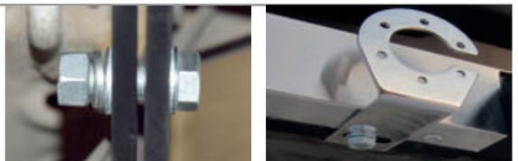
**ШАГ 7.** Затяните все резьбовые соединения. Установите глушитель на свои посадочные места. Установка завершена.
