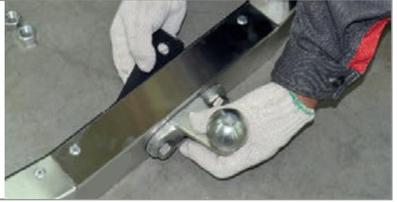
**ШАГ 2.** Высвободите глушитель с посадочного места для удобства монтажа бокового кронштейна. При необходимости прочистите резьбовые отверстия в лонжеронах.
