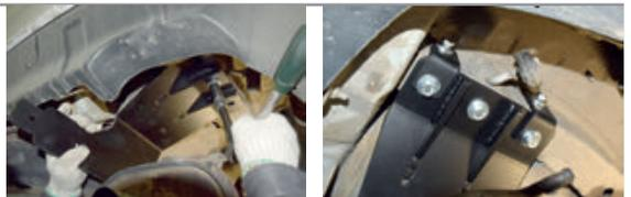
**ШАГ 5.** Установите балку ТСУ между боковых, совместив отверстия балки ТСУ и боковых кронштейнов, и соединив всё с помощью болтов М12х1,25х40 через шайбы 12 с двух сторон и шайбы 12 гроверные, гайками М12х1,25
