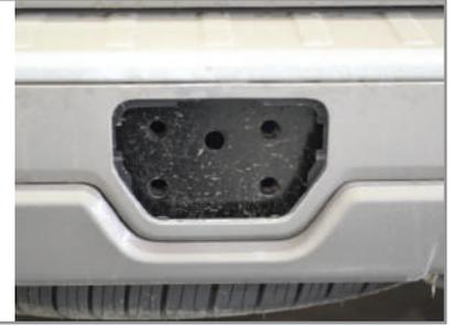
**ШАГ 2.** Для установки балки ТСУ совместите отверстия в балке с выполненными автопроизводителем отверстиями в задней поперечине рамы. Прикрутите ТСУ к задней поперечине рамы с помощью болтов M12x1,25x40, через шайбы 12 и шайбы 12 гроверные. Отрегулируйте положение балки ТСУ относительно задней поперечины рамы и затяните все соединения.
