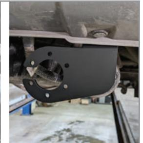
**ШАГ 5.** Установите фиксирующий болт M10x20 снизу, он используется для исключения технологических люфтов съёмного шара и только в ненагруженном состоянии! Перед сцепкой болт демонтировать! Установка завершена.
