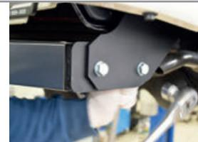
**ШАГ 3.** Отрегулируйте положение балки ТСУ относительно бампера автомобиля, обеспечив минимальный зазор 10 мм. Затяните все резьбовые соединения начиная с боковых кронштейнов. Установите съемный шар в сборе и закрепите его пальцем гнутым.
