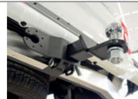
**ШАГ 5.** Зафиксируйте съемный шар болтом M10x20 снизу, он используется для исключения технологических люфтов съемного шара и только в ненагруженном состоянии! Перед сцепкой болт демонтировать!
