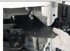
**ШАГ 2.** Установите балку ТСУ, совместив отверстия балки ТСУ с отверстиями боковых кронштейнов. Соедините всё с помощью болтов M12x1,25,40 через шайбы 12 с двух сторон и шайбы 12 гроверные, гайками M12x1,25. Соединения не затягивайте.
