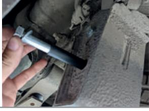
**ШАГ 3.** Установите в правый лонжерон закладную деталь малую в отверстие, следующее от выкрученного штатного болта. Используя болт M12x1,25x40 с шайбой 12 и шайбой 12 гроверной вместо демонтированного штатного болта, зафиксируйте правый кронштейн, наживите гайку M12x1,25, шайбу 12 и шайбу 12 гроверную на установленную ранее закладную.
