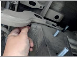
**ШАГ 2.** Используя болт M12x1,25x40 с шайбой 12 и шайбой 12 гроверной вместо демонтированного штатного болта, зафиксируйте левый кронштейн, наживите гайку M12x1,25, шайбу 12 и шайбу 12 гроверную на установленную ранее закладную. Далее через отверстия в усилителе боксировочной петли зафиксируйте левый кронштейн, используя болты M12x1,25x140, шайбы 12, втулки 15, шайбы 12 гроверные и гайки M12.
