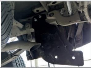
**ШАГ 4.** Вставьте большую закладную деталь в правый лонжерон так, как показано на схеме. Установите правый дополнительный кронштейн на шпильки закладной, используя шайбы 12, шайбы 12 гроверные и гайки M12x1,25.
