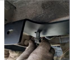
**ШАГ 4.** Установите балку ТСУ, на левый и правый кронштейны, используя для крепления болты M10x1,25x30, гайки M10, шайбы 10 гроверные и шайбы 10. Отрегулируйте положение балки и затяните все резьбовые соединения. Подключите датчик, ранее закрепленный на балке ТСУ. Установите кронштейн крепления электрической розетки на балку ТСУ, используя болт M10x30, гайку M10, шайбу 10 гроверную и шайбу 10.
