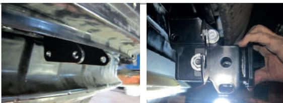
**ШАГ 5.** Установите съемный шар в сборе и зафиксируйте его с помощью пальца гнутого, гальванизированного и шплинта пружинного. Затяните шар с помощью ключа на 38 мм. Вкрутите стопорный винт М10х20 снизу, **он используется для исключения технологических люфтов съемного шара и только в ненагруженном состоянии! Перед сцепкой болт демонтировать!**
