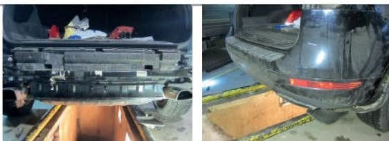
**ШАГ 4.** Установите кронштейн нижний, совместив отверстия в нём с отверстиями в балке ТСУ. Закрепите нижний кронштейн с помощью болтов М12х1,25х120 и гаек М12х1,25 нейлоновых. Установите кронштейн розетки и зафиксируйте его с помощью гайки М10 через шайбу 10 увеличенную и шайбу 10 гроверную.
