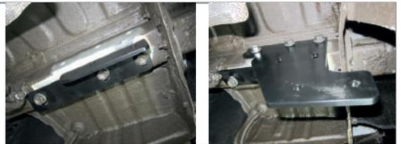
**ШАГ 4.** Установите балку ТСУ, совместив отверстия в боковых кронштейнах с отверстиями балки ТСУ, и соедините их с помощью болтов M10x40 через шайбы и шайбы 10 гроверные.
