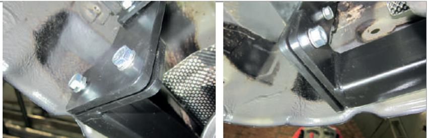
**ШАГ 5.** Установите кронштейн розетки и закрепите его с помощью болта M10, шайбы 10 гроверной и шайбы 10. Затяните все соединения, отрегулировав положение ТСУ. Установите съёмный шар в сборе и закрепите его пальцем гнущим гальванизированным со шплинтом пружинным игольчатый. Затяните шар ключом на 38 мм. Установите задний бампер, согласно руководства по ремонту автомобиля.
