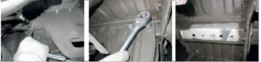
**ШАГ 2.** Установите кронштейн левый, совместив отверстия кронштейна с отверстиями в лонжероне автомобиля и соедините их с закладными пластинами с помощью болтов M10x1,25x40 через шайбы 10 и шайбы 10 гроверные.
