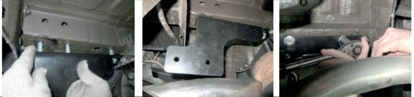
**ШАГ 3.** Установите уголок, совместив отверстия уголка с отверстиями в нижней части правого лонжерона автомобиля и соедините их с помощью болтов крепления проушины. Аналогично установите кронштейн правый и соедините его с отверстиями на боковой части лонжерона автомобиля и с отверстиями в уголке с помощью двух болтов M10x40, гайками M10, через шайбы 10 и гроверы 10.
