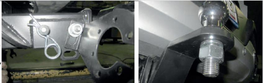
**ШАГ 6.** Установите фиксирующий болт M10x20 снизу, он используется для исключения технологических люфтов съёмного шара и только в ненагруженном состоянии! Перед сцепкой болт демонтировать! Шар в сборе может устанавливаться по вылету в два положения. Установка завершена.
