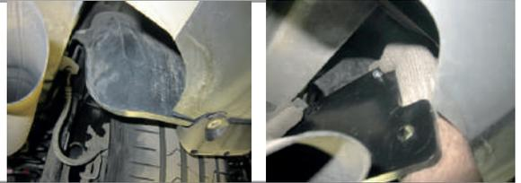
**ШАГ 3.** Установите балку ТСУ, совместив отверстия в кронштейнах боковых и балке ТСУ. Закрепите кронштейн с помощью болтов М10х40х1,25, гайками М10х1,25 через шайбы 10 и шайбы 10 гроверные. Отрегулируйте положение балки ТСУ относительно бампера и затяните все соединения.
