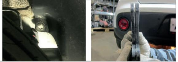
**ШАГ 2.** Для установки кронштейна бокового, отыщите два отверстия с закладными гайками в заднем лонжероне автомобиля. Прикрутите кронштейн к внешней, боковой стороне лонжерона с помощью болтов М10х1,25х40, через шайбы 10 и шайбы 10 гроверные. На другой стороне автомобиля кронштейн боковой устанавливается аналогично. Соединения не затягивайте
