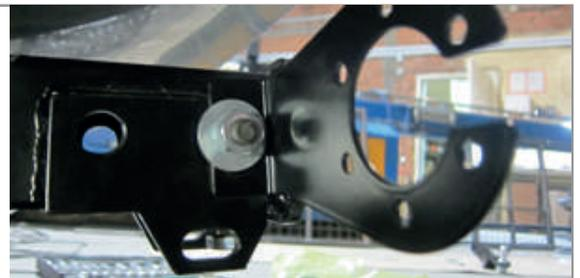
**ШАГ 5.** Установите фиксирующий болт М10х20 снизу, он используется для исключения технологических люфтов съёмного шара и только в ненагруженном состоянии! Перед сцепкой болт демонтировать! Закрепите брызговики.
