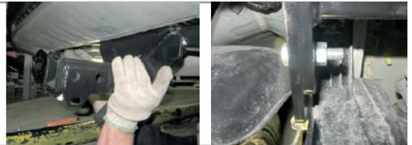
**ШАГ 4.** Установите кронштейн розетки и закрепите его на шпильке с помощью гайки М10 через шайбу 10 увеличенную и шайбу 10 гроверную. Установите съёмный шар в сборе и закрепите его пальцем гнутым гальванизированным со шплинтом пружинным игольчатым. Затяните шар ключом на 38 мм.
