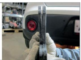
**ШАГ 2.** Для установки кронштейна бокового, отыщите два отверстия с закладными гайками в заднем лонжероне автомобиля. Прикрутите кронштейн к внешней, боковой стороне лонжерона с помощью болтов M10x1,25x40, через шайбы 10 и шайбы 10 гроверные. На другой стороне автомобиля кронштейн боковой устанавливается аналогично. Соединения не затягивайте.
