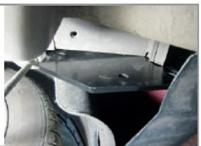
**ШАГ 3.** Установите балку ТСУ, совместив отверстия в кронштейнах боковых и балке ТСУ. Закрепите кронштейн с помощью болтов M10x1,25x40, гайками M10x1,25 через шайбы 10 и шайбы 10 гроверные. Отрегулируйте положение балки ТСУ относительно бампера и затяните все соединения.
