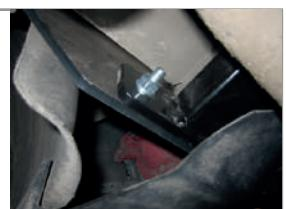
**ШАГ 4.** Установите кронштейн розетки и закрепите его на шпильке с помощью гайки M10 через шайбу 10 увеличенную и шайбу 10 гроверную. Установите съемный шар в сборе и закрепите его пальцем гнутым со шплинтом. Затяните шар ключом на 38 мм.
