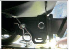
**ШАГ 5.** Установите фиксирующий болт M10x20 снизу, **он используется для исключения технологических люфтов съемного шара и только в ненагруженном состоянии!** Перед сцепкой болт демонтировать! Установите брызговики на место согласно руководству по ремонту и эксплуатации автомобиля.
