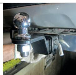
Выровняйте фаркоп и затяните все резьбовые соединения. Установите съёмный шар в сборе и закрепите его пальцем гнутым гальванизированным со шплинтом пружинным игольчатым. Затяните шар ключом на 38 мм. Установите фиксирующий болт M10x20 снизу, он используется для исключения технологических люфтов съемного шара и только в ненагруженном состоянии! Перед сцепкой болт демонтируйте!
