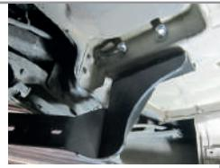
Затем закрепите кронштейн снизу с помощью болтов M10x40 через шайбы 10 и шайбы 10 гроверные.
