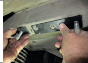
**ШАГ 3.** Установите балку ТСУ, совместив отверстия в боковых кронштейнах и в балке. Закрепите балку ТСУ с помощью болтов M10x1,25x30 через шайбы 10 и шайбы 10 гроверные гайками M10x1,25.
