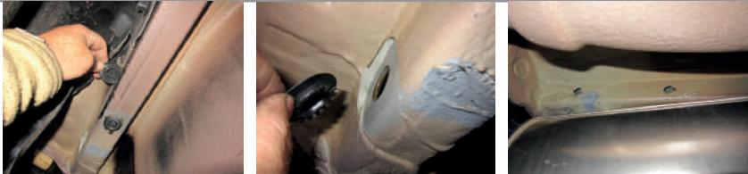
**ШАГ 3.** Проденьте сквозь лонжерон крепежные винты из комплекта поставки шляпками наружу автомобиля. Закрепите на винтах крепежные кронштейны. С помощью гаек, шайб и гроверных шайб.
