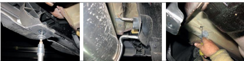
**ШАГ 2.** Удалите пластиковые заглушки с технологических отверстий с каждой стороны задних лонжеронов.
