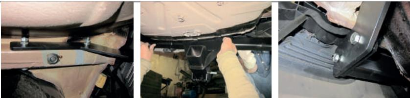
**ШАГ 5.** Установите кронштейн крепления электрической розетки, стопорный винт снизу, **используется для исключения технологических люфтов съемного шара и только в ненагруженном состоянии! Перед сцепкой болт демонтировать!** Верните глушитель на посадочное место. Закрепите нижнюю часть бампера штатными винтами.
