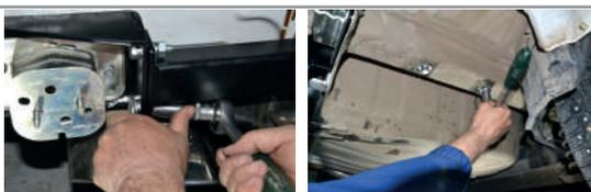
**ШАГ 5.** Установите усилитель заднего бампера на штатные метизы. Установите задний бампер и задние фонари согласно инструкции по ремонту автомобиля. Установите шар в сборе (Поз. М). Зафиксируйте шар в сборе с помощью пальца с клипсой.
