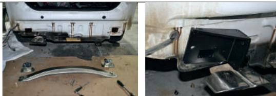
**ШАГ 2.** Закрепите кронштейны в нижней части лонжеронов болтами М10х30 через шайбы 10 увеличенные и гроверы 10. Болты не затягивать. Установите балку ТСУ (Поз. N) между боковыми кронштейнами и закрепите его с помощью болтов М10х40, через шайбы 10 с двух сторон, шайбы 10 гроверные и гайки М10. Болты не затягивать.
