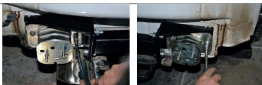
**ШАГ 4.** Затяните все болты в следующей последовательности: сначала затяните кронштейны между собой, затем болты в нижней части лонжеронов, потом болты крепления опор усилителя заднего бампера.
