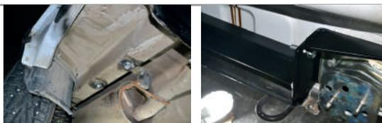
**ШАГ 3.** Установите опоры усилителя заднего бампера с помощью болтов М8х40, через шайбы 8 гроверные и шайбы 8. Соединения не затягивать.
