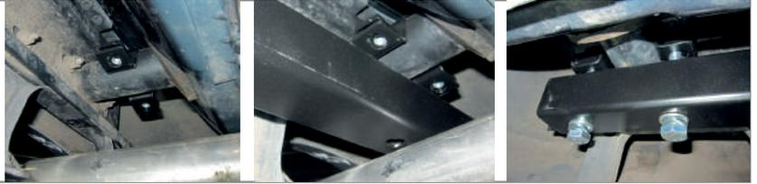
**ШАГ 2.** Для установки центрального кронштейна совместите отверстия кронштейна с отверстиями в ушках балки ТСУ и соедините болтами M12x1,25x45 через шайбы 12 и самоконтрящиеся гайки M12x1,25.
